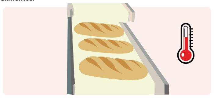
En las fábricas de galletas y panaderías se ocupan en la fabricación de masa, recorte, entrada y salida de horno, líneas de enfriamiento y empaque. Las harineras la ocupan en elevadores de cangilones y para la limpieza de harina mediante cepillos cernedores.
